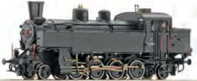
Modell einer Dampflokomotive der Reihe 93 mit Giesl-Ejektor und einem Kohlenkastenaufsatz aus Blech.
