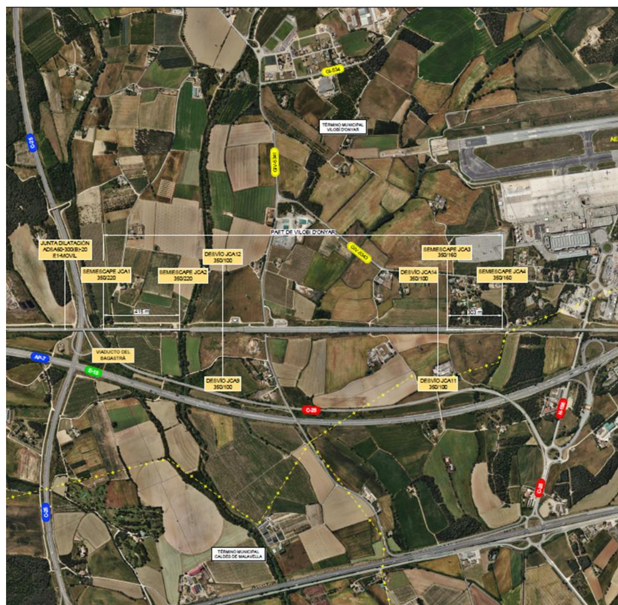
Figura 19. PAET de Vilobí. Configuración de aparatos de vía
