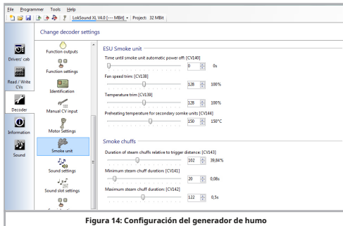
Figura 14: Configuración del generador de humo
