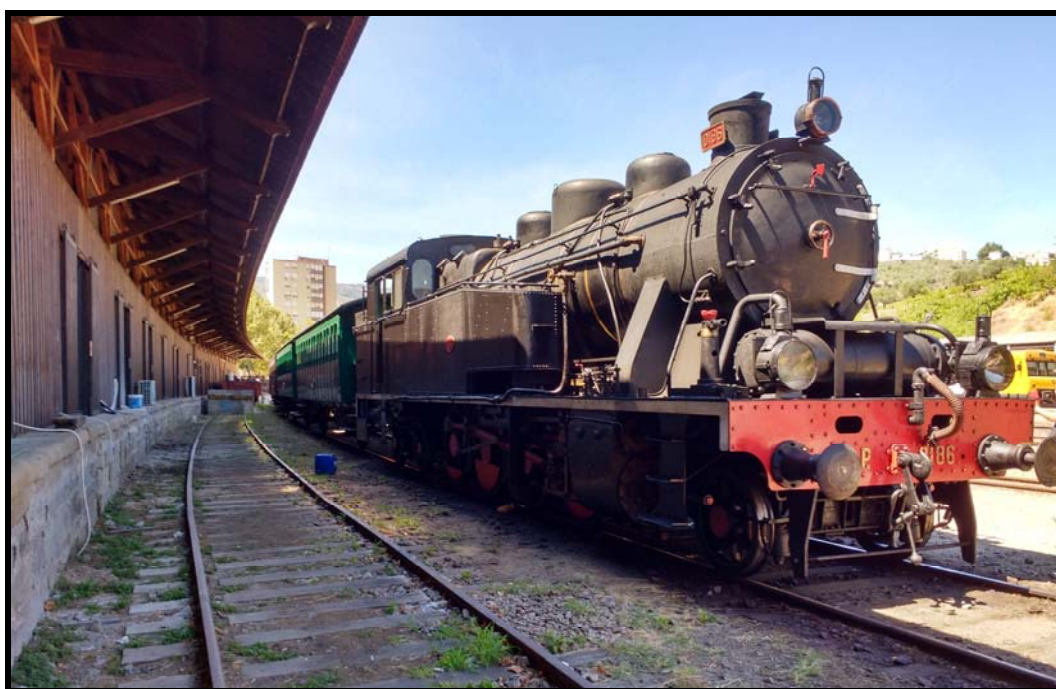
Figura 217. Locomotora-ténder (1-4-2T). Regua (Portugal)
