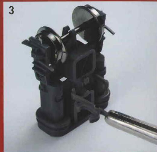
**3** A continuación, coloca los dos resortes en las dos columnas laterales del rodal, que disponen de unas muescas practicadas para tal efecto. La parte ancha del enganche de los resortes debe quedar orientada en el mismo sentido que los dos pivotes cuadrados de la columna central del rodal
