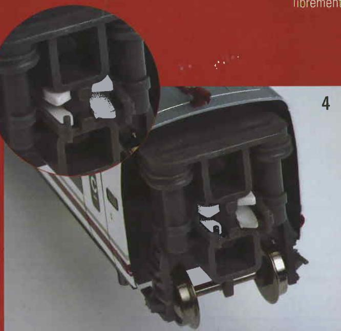
**4** Ahora, recupera la carrocería montada anteriormente para encajar el conjunto del rodal en su enganche doble. Asegúrate de que los dos pivotes cuadrados de la columna central del rodal están orientados hacia el exterior.
