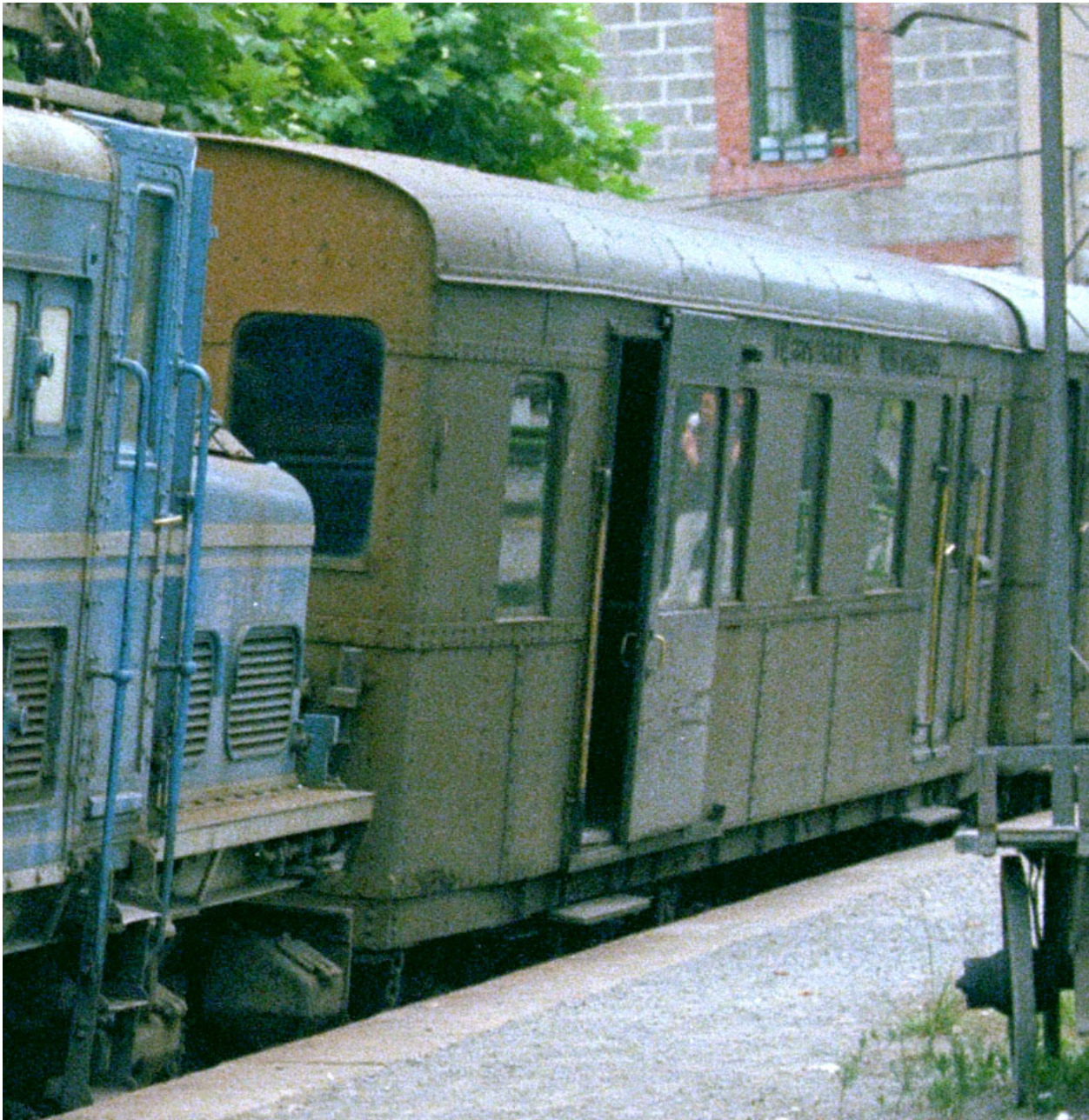
In den Jahren 1944/45 durfte CAF Beasain 10 Neubaufahrzeuge 3. Klasse liefern, davon 3 mit Gepäckabteil. TC 53 in San Sebastian, dahinter ein kurzer Umbauwagen 3. Klasse mit Gepäckabteil TCD. Die Verladetätigkeit ist noch im Gange. Leider nur eine Ausschnittvergrößerung.
