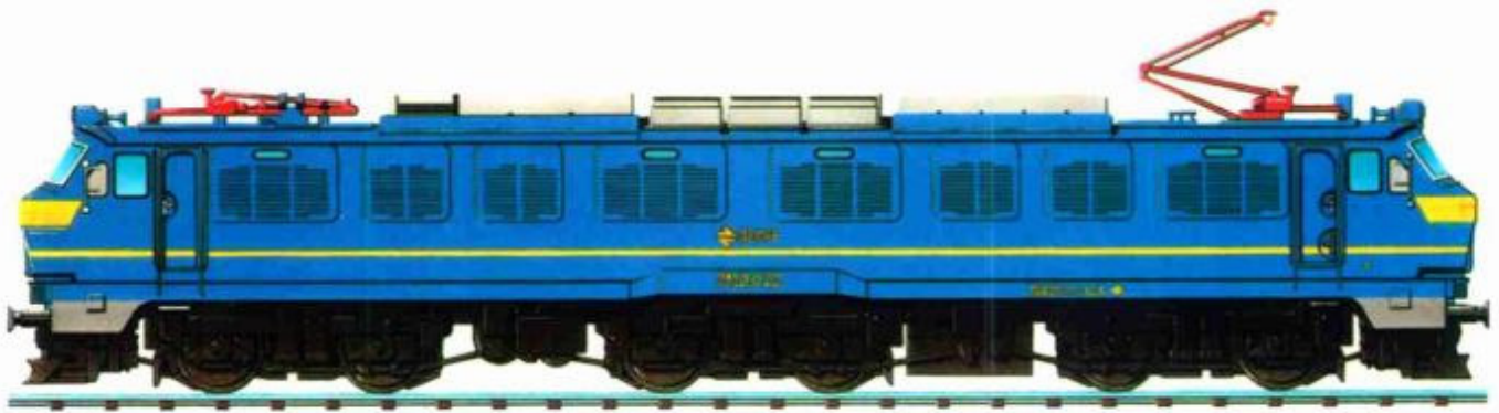
Locomotora serie 251 de 4.650 kw para 160 km/h.
