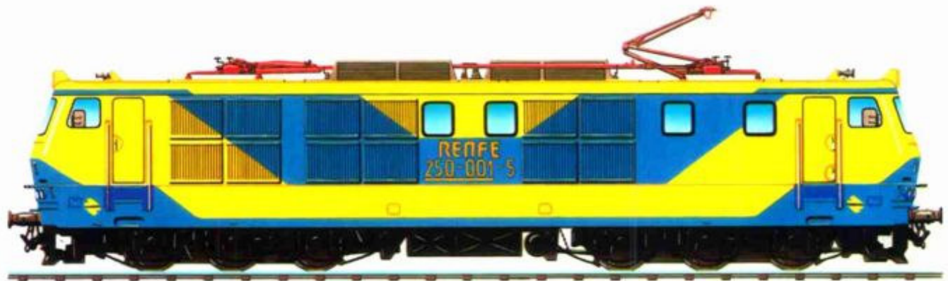
Locomotora serie 250 de 4.600 kw para 160 km/h.
