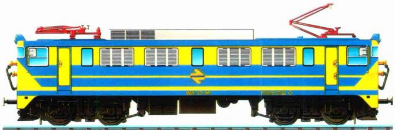
Locomotora serie 269 de 3.100 kw para 160 km/h.
