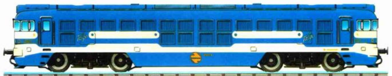
Locomotora serie 354 de 2.250 kw para 180 km/h.
