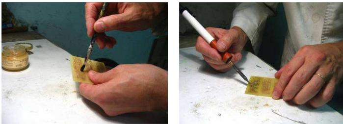
La siguiente operación es el estañado. Aunque no es imprescindible, facilitará enormemente la soldadura y además protegerá el cobre de la oxidación. Previamente barnizáis bien el cobre con Flux(una resina
