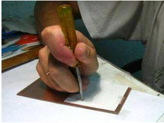
Colocad boca abajo sobre la placa(ya pulida y limpia por las dos caras como se indicó para placas sencillas) una de las caras impresas, sujetadla con unos trocitos de celo para que no se mueva y marcad con un punzón sobre la placa los agujeritos que practicásteis antes. Ahora, retirad con cuidado los celos y la hojita impresa.
