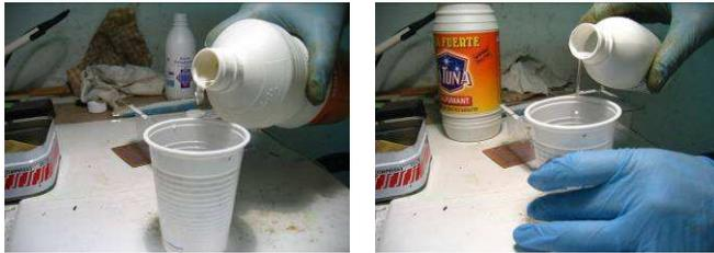
Medimos cantidades iguales de ambos líquidos y los echamos con cuidado en el recipiente plástico. Seguidamente colocamos la placa y veréis como el conjunto toma una tonalidad verde, por efecto de la reacción química. No hace falta llenar el recipiente, basta que la placa nade en un par de dedos de líquido. Para acelerar el proceso, y acabar antes moved con cuidado el recipiente, haciendo olas. Hacedlo despacio para que no desborde y no mojar la mesa.
